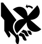
1.f. No poner las manos cerca del ventilador del motor. No tratar de sobrecontrolar el regulador de velocidad en vacío empujando las varillas de control del acelerador mientras el motor está funcionando.
